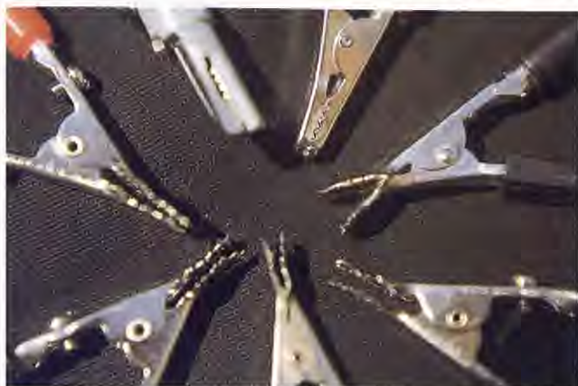
Fig. 3. Pinzas de ECG; se puede apreciar una de ellas modificada para evitar que resulte traumática.
