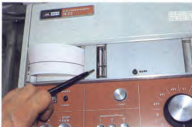
Fig. 4. Electrocardiógrafo de un canal: una sola aguja dibuja una derivación electrocardiográfica.
