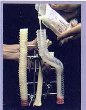
Foto 5: Relleno del segundo tubo corrugado. Hay que asegurarse de que el tubo no se colapsa en las zonas acodadas, lo que generaría una pérdida importante de resistencia.
