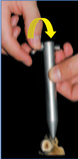
Foto 8. Sin liberar la tensión sobre la llave, se inclina el tensor para que el alambre se doble sobre sí mismo en el lado contrario al asa.
