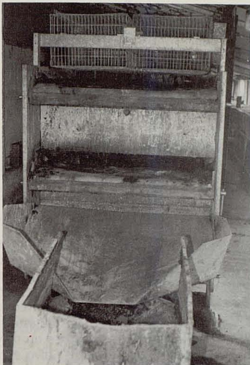
Granja del Sr. Martín, en Corbera de Llobregat, mostrando el carrito en el que se recogen las deyecciones transportadas por la cinta.
