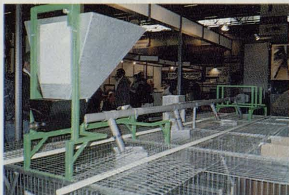
Distribución automática del pienso en tolvas comunes para cuatro jaulas.
