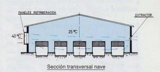
El sistema de refrigeración por extracción, con nuestros paneles que se acoplan a cualquier ventana, funciona con sus extractores, por lo que por 33.000 pesetas que vale un módulo de 2 paneles completo, con bomba, etc., puede refrigerar 7.000 m³ hora de aire.
