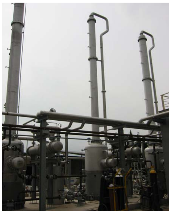
Planta recuperación de disolventes. Torres de destilación
