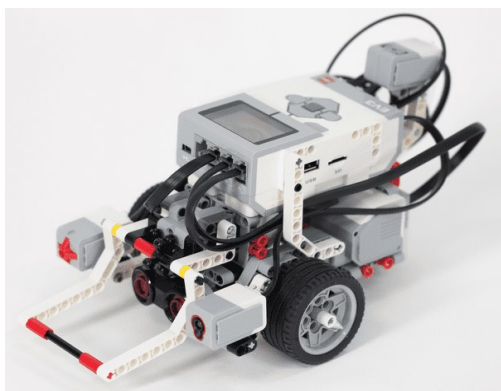
Figura 1. Aspecto robot Lego con sensores básicos incorporados.
