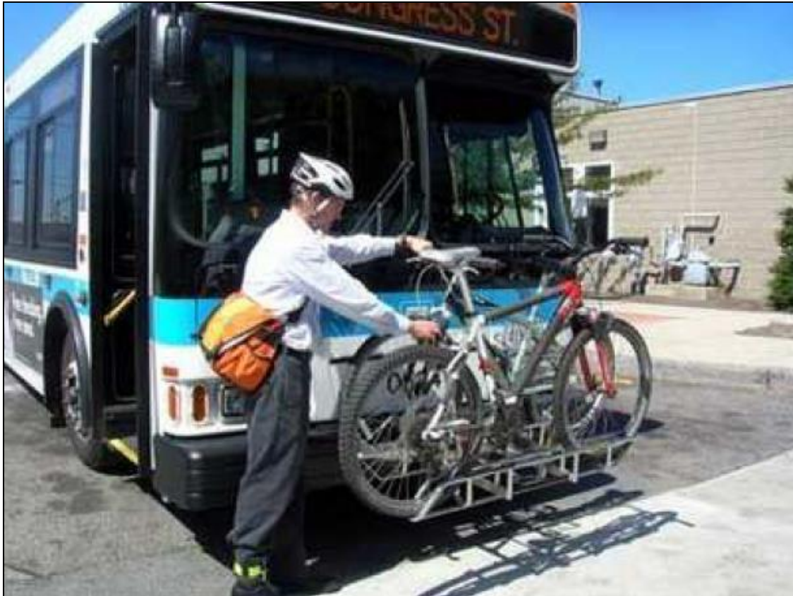
Exemple de rack incorporat a l'autobús.
