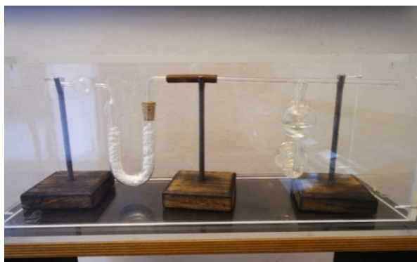
Fig. 2. Processo de análise com o Kaliapparat. Fonte: Foto tirada pelo autor em Liebig Museum Sala 10 - Chemiemuseum in Gießen
