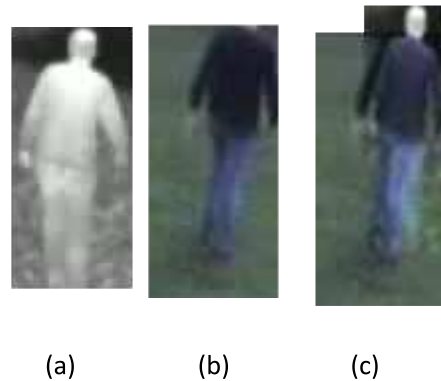
Figura 3.17: Fusión de regiones de interés en infrarrojo y color. (a) ROI en infrarrojo. (b) ROI en color. (c) ROI obtenida tras la fusión.
