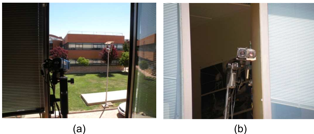
Figura 3.11: Montaje realizado para la captura simultánea en los espectros infrarrojo y color. (a) Vista trasera. (b) Vista delantera.
