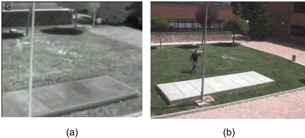
Figura 3.14: Imagen capturada a temperatura alta. (a) Espectro infrarrojo. (b) Espectro visible.
