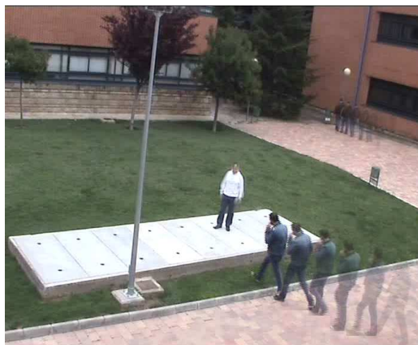
Figura 3.21: Ejemplo de análisis de trayectorias (dibujado sobre un fotograma), teniendo en cuenta las últimas posiciones de los humanos en la secuencia.
