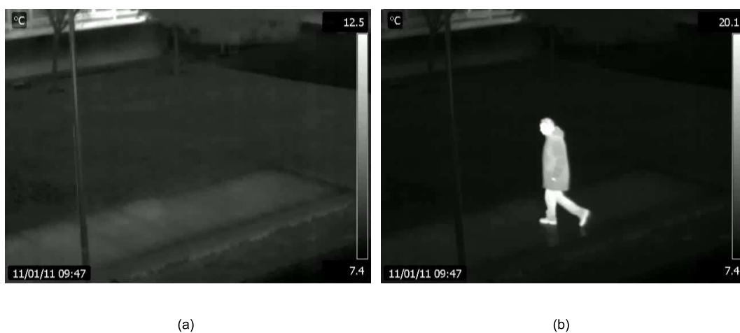
Figura 3.13: Cambio automático de la escala de niveles de gris de la cámara en infrarrojo. (a) Escena sin humano. (b) Escena con humano.
