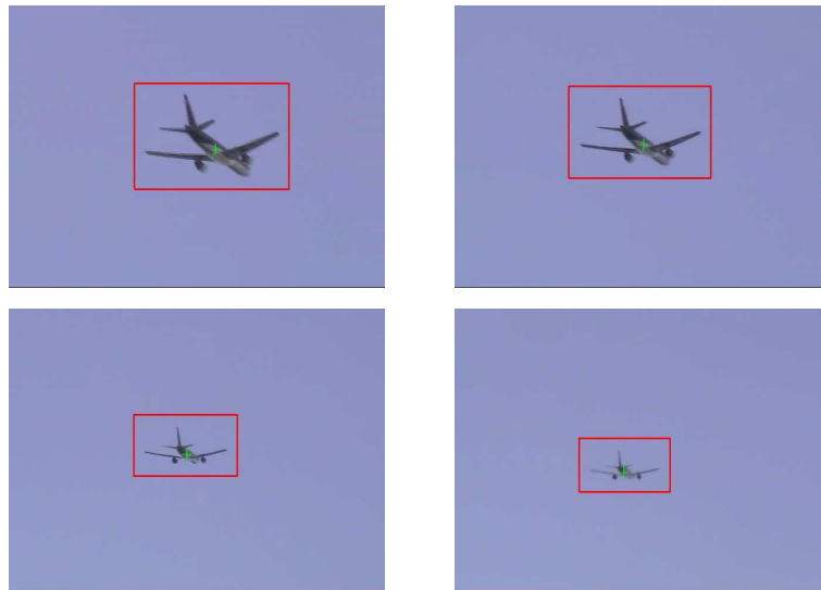
Figura 2.12: Ejemplo de seguimiento basado en puntos, extraído de EMSI (2007)
