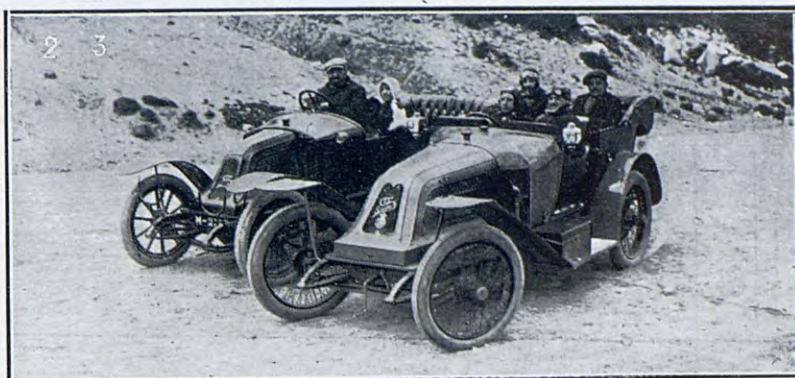
(1) 11 HP., 82 X 140, con 1.808 kilos, con ocho asientos, gana Medalla de Oro en el Concurso de Navacerrada. — (2) 12 HP., 75 X 130, con 1.437 kilos sube al puerto de Guadarrama en doce minutos cincuenta segundos y el de Navacerrada en 25 minutos. — (3) 26 HP., tipo "SPORT", 96 X 190, con 1.572 kilogramos subió en el Concurso de Navacerrada en diez y seis minutos seis segundos; 5.º de la clasificación general. Sube a Guadarrama en cuatro minutos, cincuenta y ocho segundos.
