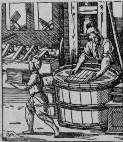
Primitivo procedimiento para la fabricación del papel de imprimir en el siglo XVI
