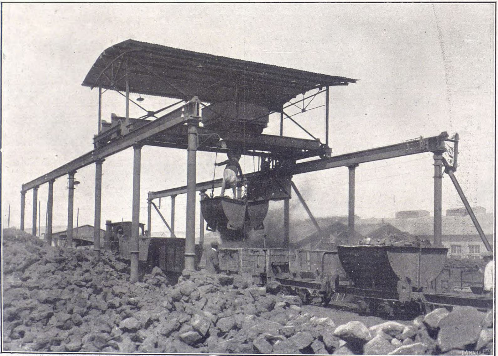
El transbordador para la carga de minerales, efectuando el cargamento de un tren con destino al muelle "Villanueva"
