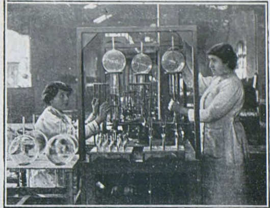
Soldadura de la ampolla de cristal con el soporte donde va montado el filamento
