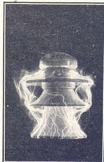
Aislador bajo una tensión de 155.000 voltios
