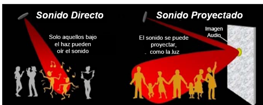
Fig. 32 - Principio de proyección geométrica del haz sonoro.
