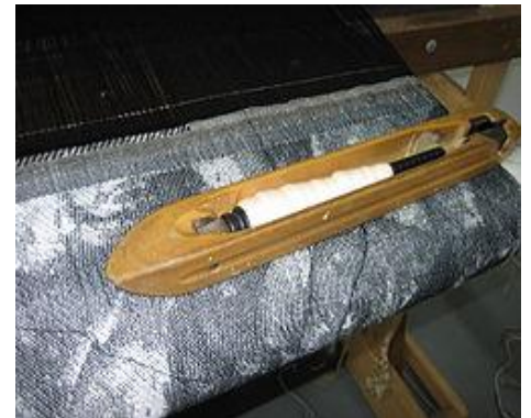
Llançadora volant inventada el 1733 per John Kay
