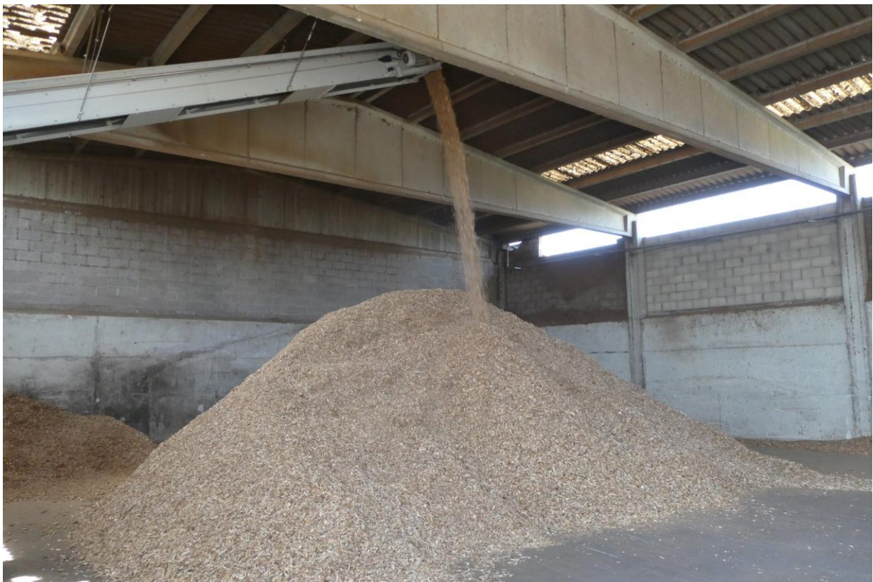
Desde la máquina de cribado, por la cinta transportadora, se va apilando la astilla G50, para su almacenaje (Santa Coloma, 2022)
