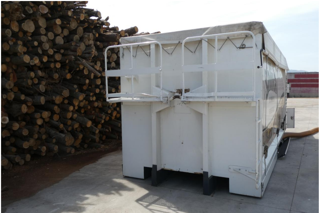
Contenedor de gancho de 30 m 3 , con descarga neumática, para biomasa (Santa Coloma, 2022)
