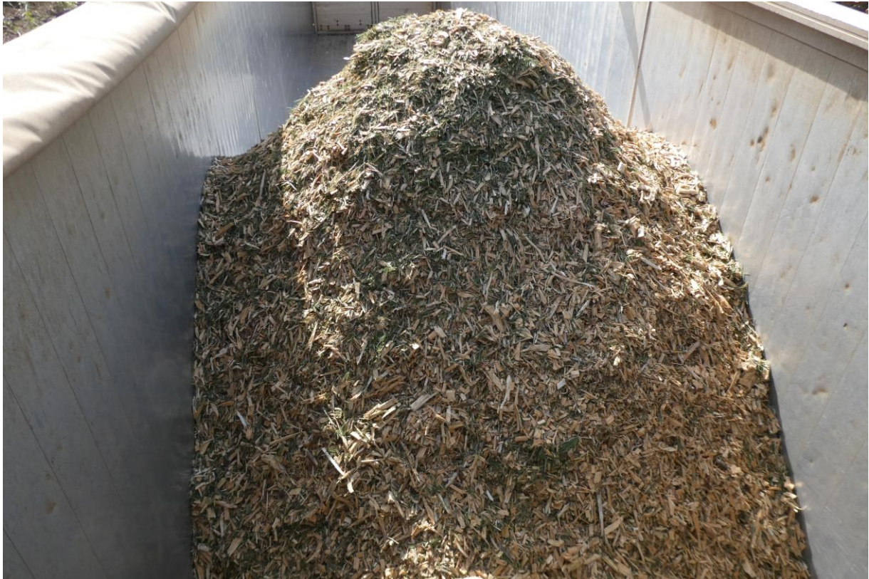
El producto final obtenido en el bosque, ya cargado en el tráiler: astilla G80 (Empordà, 2022)
