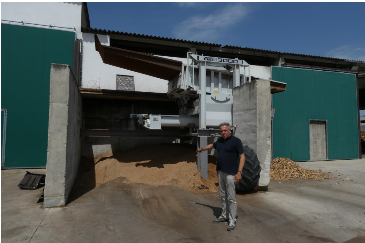
En la campa, Miquel Soliva delante de la máquina de cribado, mostrando los finos separados. A la derecha, el descarte (> 5 cm), que irá para astilla industrial G80 (Santa Coloma de Farners, 2022)
