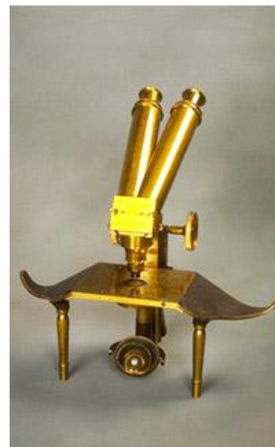
Microscopi binocular de dissecció , inventat per John Ware Stephenson (1872)
