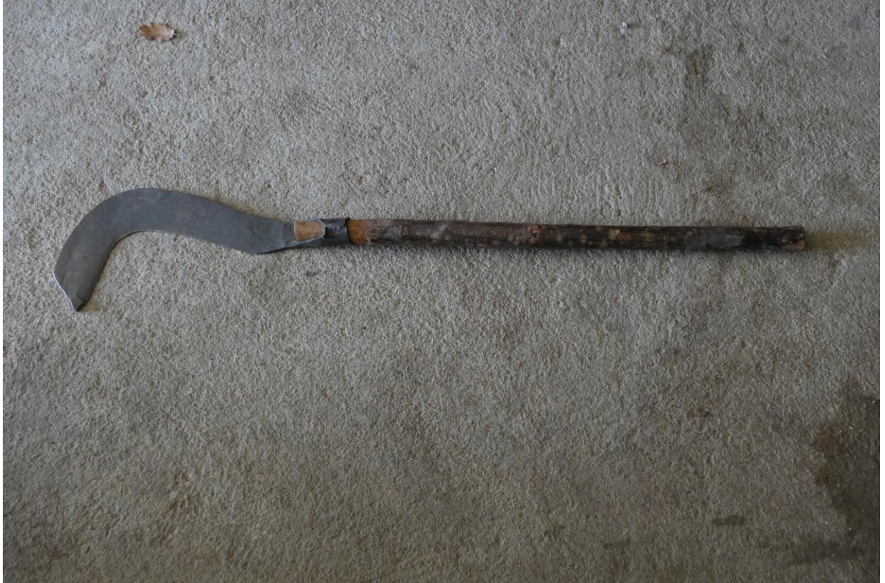
Dall para eliminar arbustos y zarzas. Obsérvese la forma de la parte de hierro, los detalles de su encaje con el mango y la punta roma y gruesa
