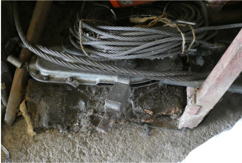
Tractel con su cable y su palanca, para sujetar y dirigir la caída del árbol
