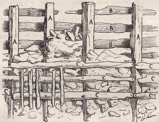
Fig. 18.—Construcción de un muro de gallinero.
