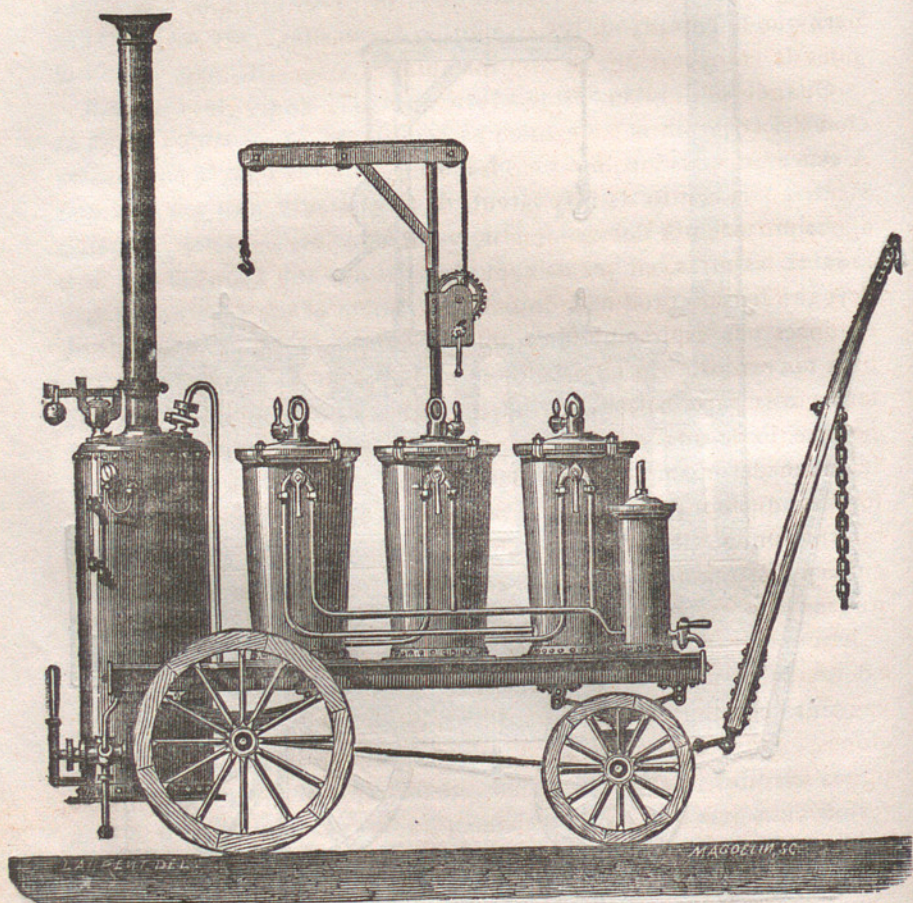
Fig. 17.—Aparato destilatorio, con calentamiento al vapor y caldera independiente.
