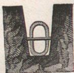
Fig. 101. — Tubo de desagüe formado por dos tejas.
