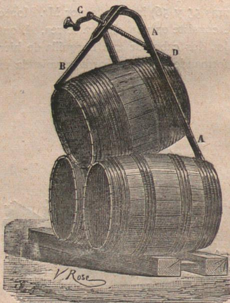
Fig. 56.—Aplicación del cric á las pilas de toneles.
