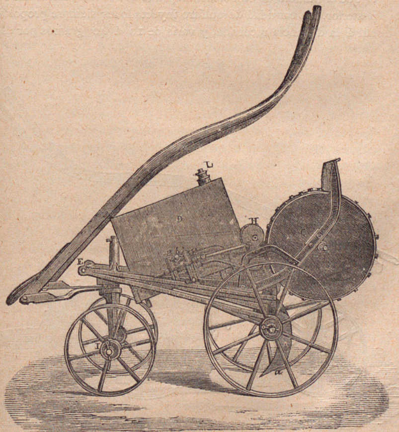
Fig. 23.—Arado sulfurador de Mr. Gastine en reposo.
