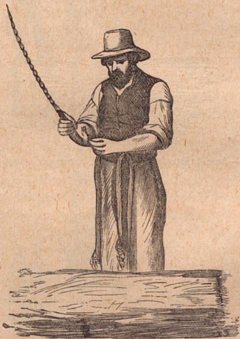
Fig. 52.—Acto de sujetar el obrero un nudo del ramal al gancho de la aguja.
