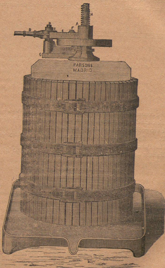
Fig. 4.<sup>a</sup>—Prensa Hércules para estrujar el orujo de la uva.
