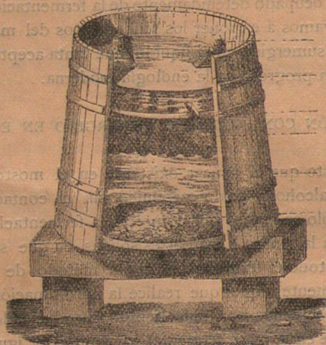
Fig. 1.<sup>a</sup>—Corte de un tino de fermentación; *a*, cañas; *b*, mosto; *c*, falso fondo; *d*, vinaza y mosto; *f*, depósito de heces.
