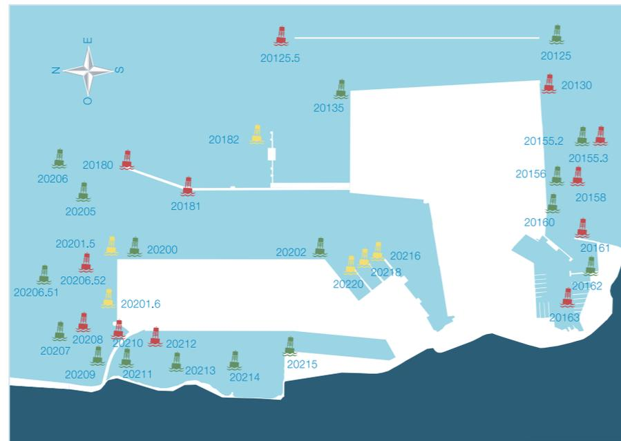
Planta esquemática del balizamiento de las aladrabas e instalaciones piscícolas dependientes de la APBA
