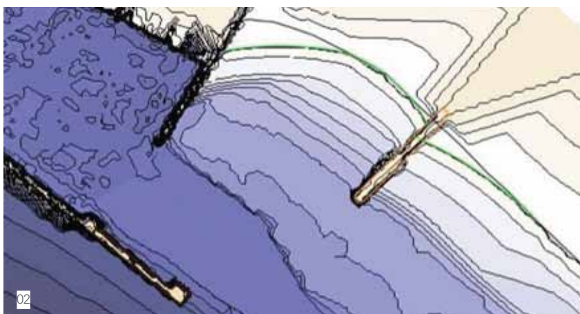
01. Batimetría regenerada con espigón perpendicular a la costa ( a=22^\circ ; D50=0,16 mm)
