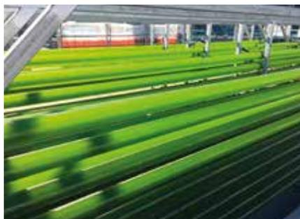
**A4HW:** Reactor tubular de microalgas para valorización del CO<sub>2</sub> en Central Litoral de Almería.
