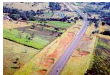
Detalles de las represas y estanques construidos para la recogida de aguas pluviales y de escorrentía en Brasil.
