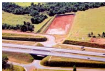
Detalles de las represas y estanques construidos para la recogida de aguas pluviales y de escorrentía en Brasil.
