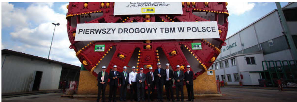
Tuneladora tipo hidroescudo con un diámetro de excavación de 12,60 m, la mayor usada en Polonia y por el Grupo OHL.
