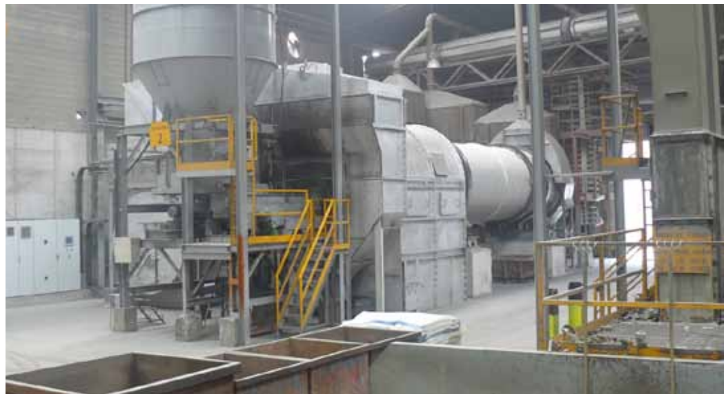
Secadero de viruta de aluminio en las instalaciones de Befesa Aluminio en Las Franquesas del Vallés, España
