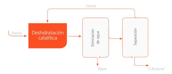
La solución propuesta por Abengoa de producción de n-biobutanol mediante catálisis ofrece importantes ventajas. Tiene como elemento principal el reactor donde el bioetanol atraviesa el lecho catalítico formando n-biobutanol y algunos coproductos. El n-biobutanol se aisla del resto de coproductos mediante un proceso de separación y posteriormente se purifica hasta llegar a las especificaciones comerciales.
