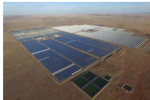
Xina Solar One, planta de colectores cilindroparabólicos con almacenamiento desarrollada por Abengoa en Sudáfrica.
