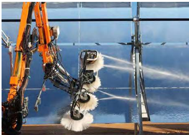
Vehículo de limpieza de colectores cilindroparabólicos.
