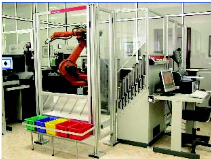
Laboratorio robotizado, ensayos de dureza. Centro de Investigación y Ensayos "José M e Aguirre Gonzalo".
