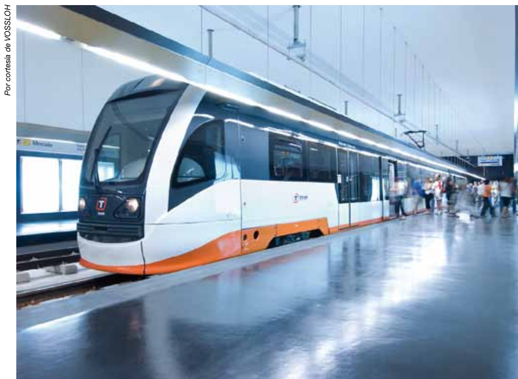
Tranvía con estructura realizada en acero inoxidable
