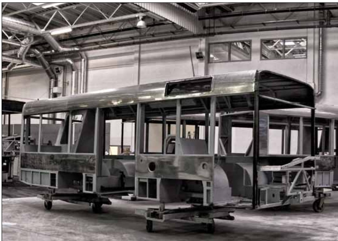
Chasis de autobús urbano fabricado en acero inoxidable.
