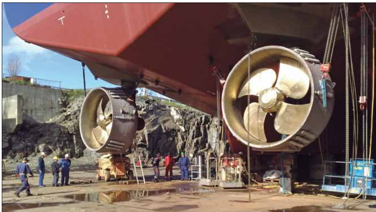
Hélices y toberas de buque fabricadas en acero inoxidable.
