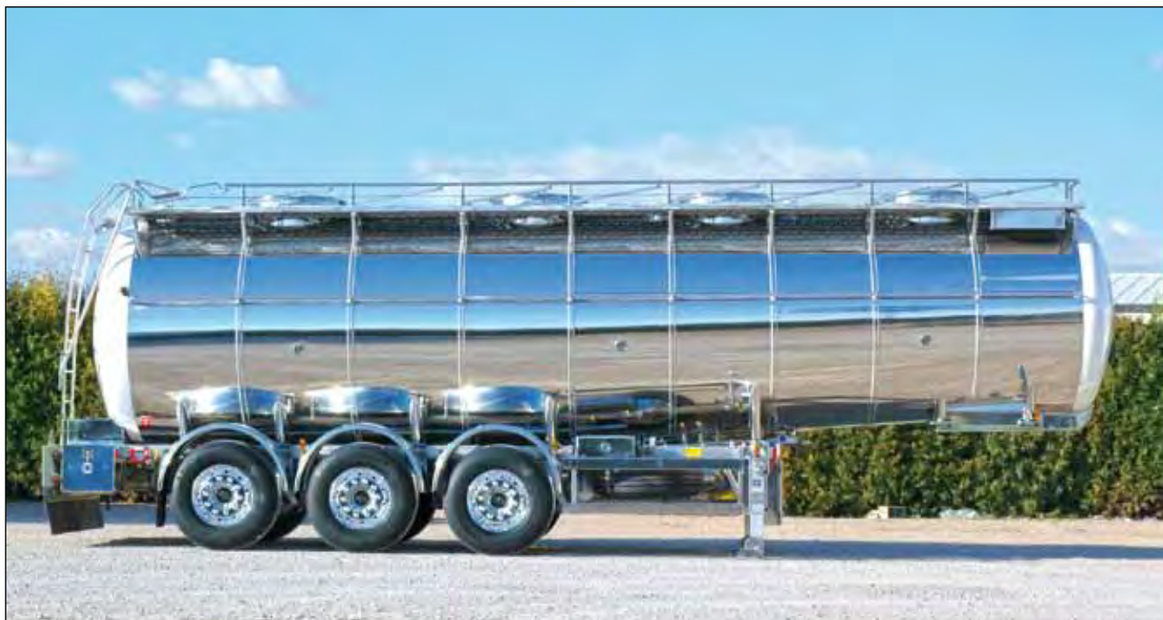
Cisterna de camión fabricada en acero inoxidable.
