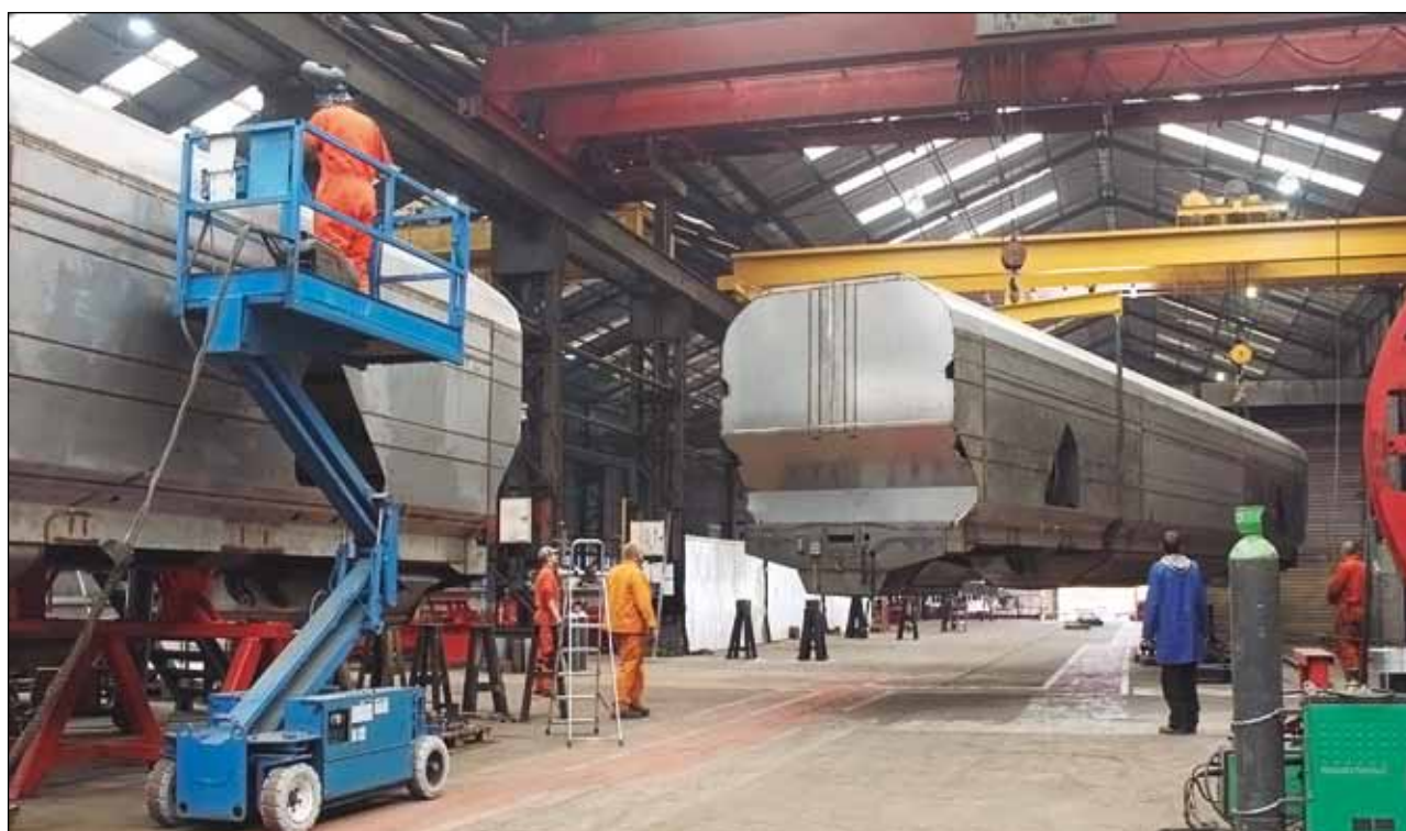
Fabricación en acero inoxidable de vagones de tren para el transporte de biomasa.
