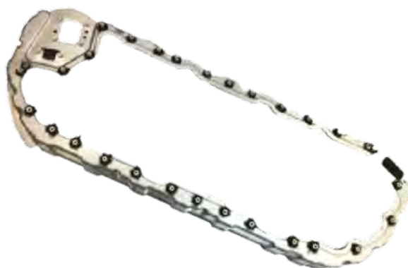
COMPONENTES BATERÍA Estampación y remachado
