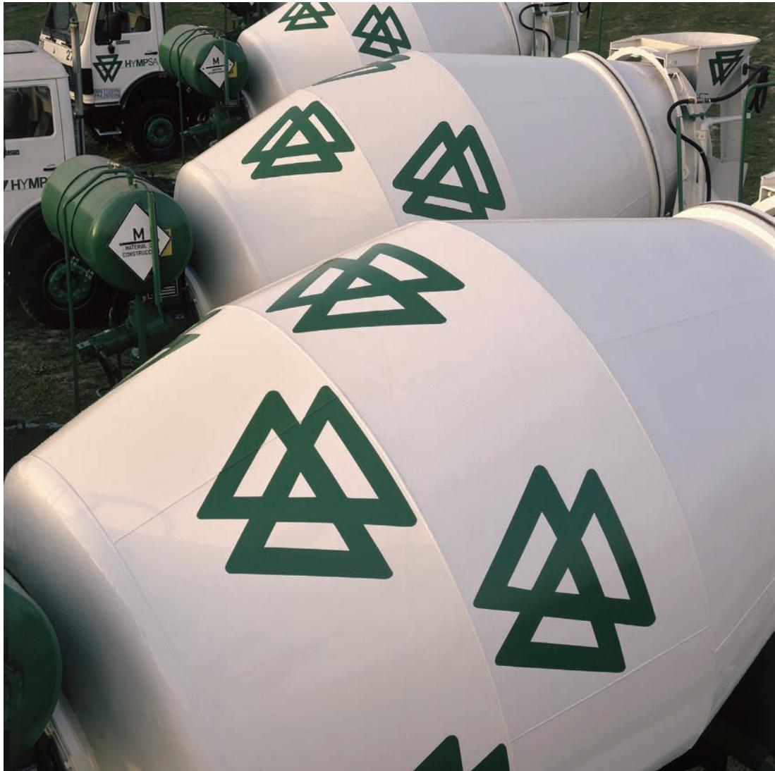
Y, por último, los hormigones confeccionados con el cemento anterior Ultraval que, por sus posibilidades de puesta en servicio inmediata, se les ha denominado Hormigones Express, y se ha trabajado en el diseño de un camión hormigonera con control de temperatura de agua y aditivos, con el objetivo principal de poder suministrar este tipo de producto sin dificultades.
