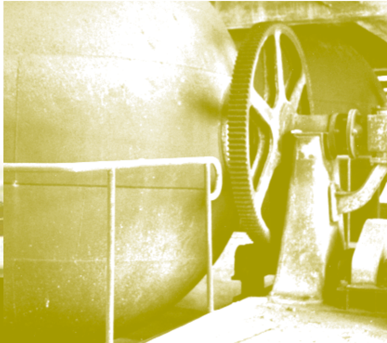
Antigua maquina Lejiadora para fabricación de pasta de papel, 1958.
