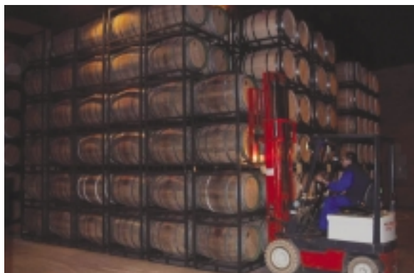
Bodega de barricas con el nuevo sistema de durmientes
