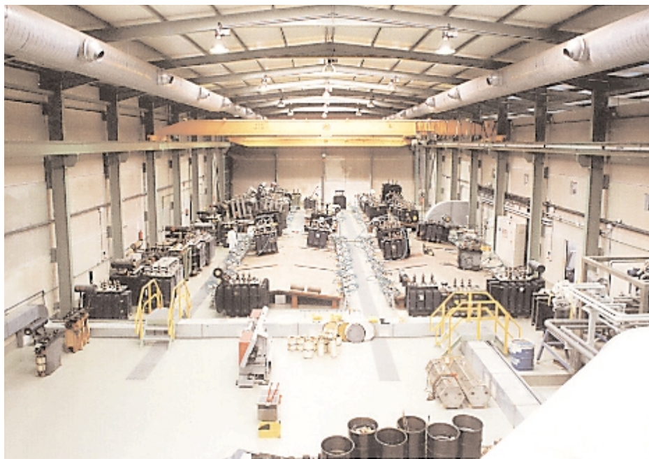
▲ Etrinsa: planta especializada en la descontaminación de transformadores con PCB.
