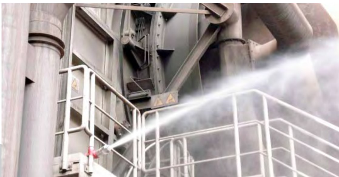
Prueba de pulverización externa de la boquilla postcombustión
