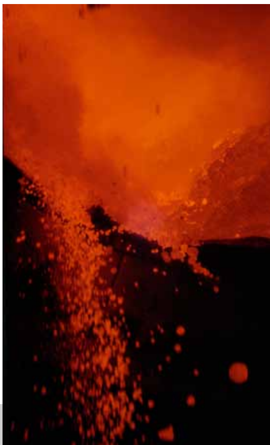
Caída de escorias en el horno waelz de Befesa Zinc Aser en Erandio, España.
