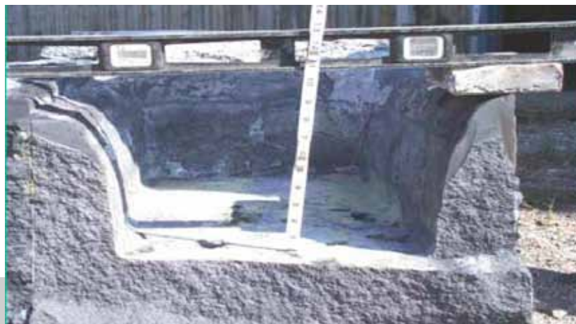
Celda usada en la electrolisis primaria de aluminio (SPL).
